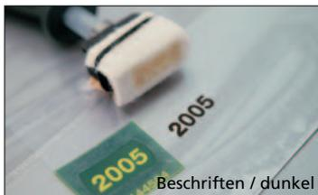
(Signieren Schwarz) - Nach gründlicher Reinigung der Flächen mit Cleanox 1 oder 2, werden die Zeichen, Schriften oder Zahlen mittels Schablonen elektrochemisch, tiefschwarz eingätzt. Bei größerer Stromdichte geht die Ätzung tiefer, ähnlich einer Gravur.
